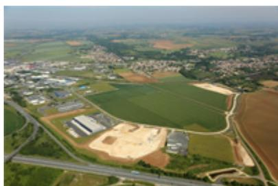
Le pôle compte également une installation terminale embranchée (I.T.E.) équipée pour les manipulations liées au fret ferroviaire, permettant de répondre à une demande croissante de transport multimodal (rail-route) et des services associés. Les entreprises PSI et OCERAIL utilisent régulièrement le rail pour acheminer coils de fer et céréales, réalisant ainsi des économies sur le transport.
